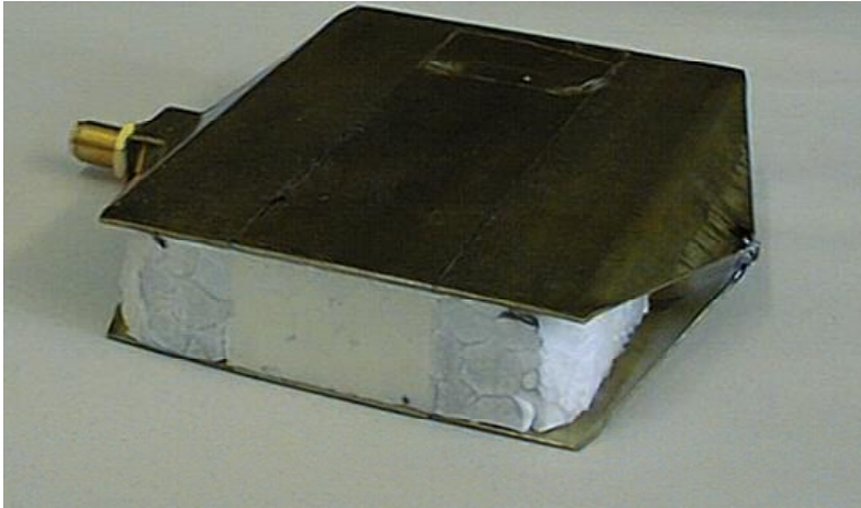
Abbildung 64: Foto der Huygenschen Antenne der Maße: f_{max} : 1500 MHz l_{max} : 7,8 cm h : 1,6 cm b : 8 cm
