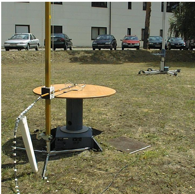
Abbildung 47: Messaufbau zur Messung des Einflusses des Drehtischs bei Freifeld-Feldstärkemessungen
