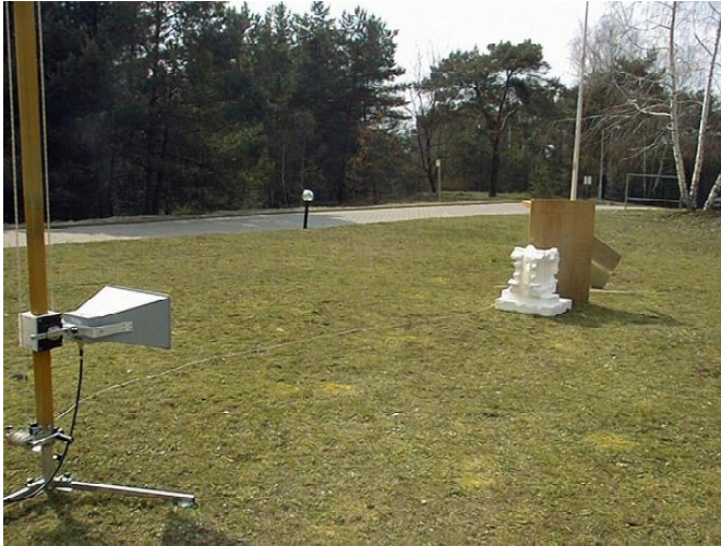
Abbildung 77: Reflexionsmessung auf dem Freifeld mit Tisch als Untersuchungsobjekt
